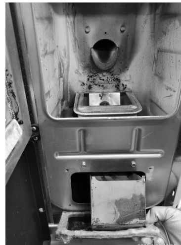
Fig. 67 - Den Inspektionsstopfen entfernen
