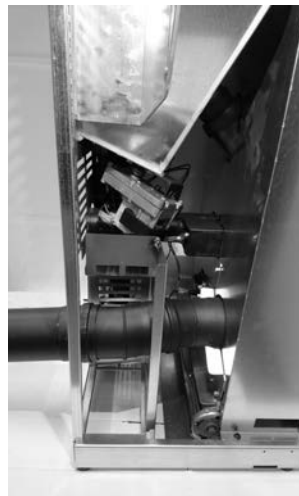
Fig. 49 - Rückwärtigen Rauchgasabzugs Sharp
