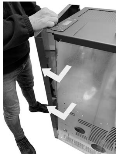
Fig. 35 - Entfernen der Seiten
