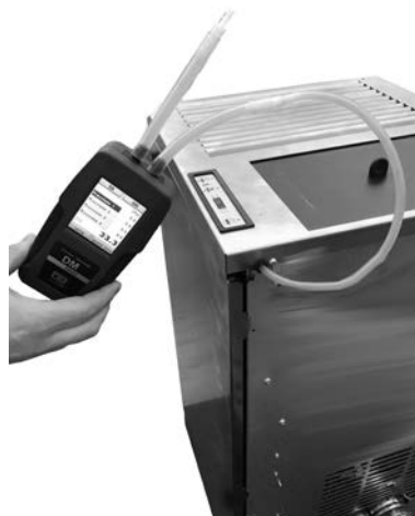
Fig. 61 - Anschluss des Digitaldruckwächters
