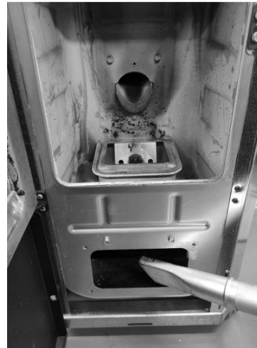
Fig. 69 - Die Asche absaugen
